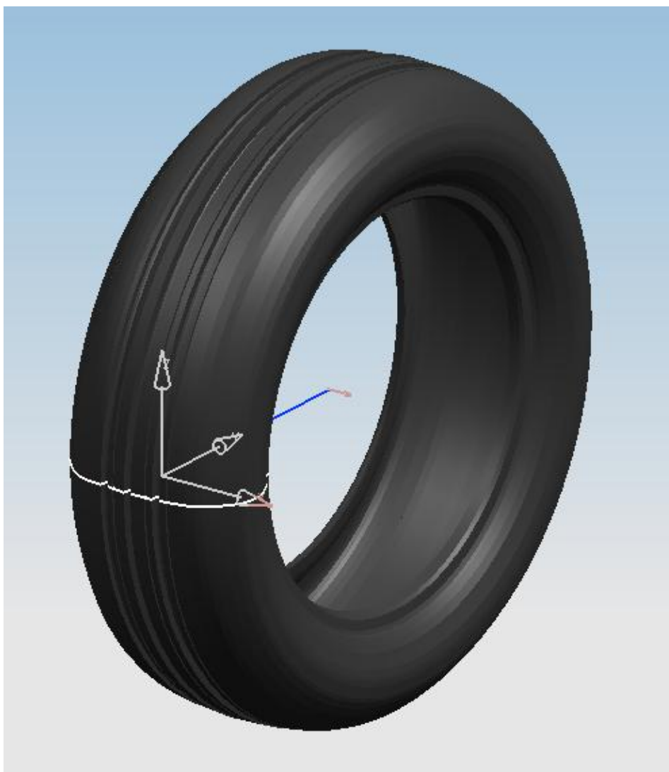
Figura A.2 – Geometria estimada da seção transversal do pneu 175/65.
